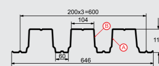
Профилированный лист Н-114x600-A,B Толщина материала 0.7 - 1.0 мм
